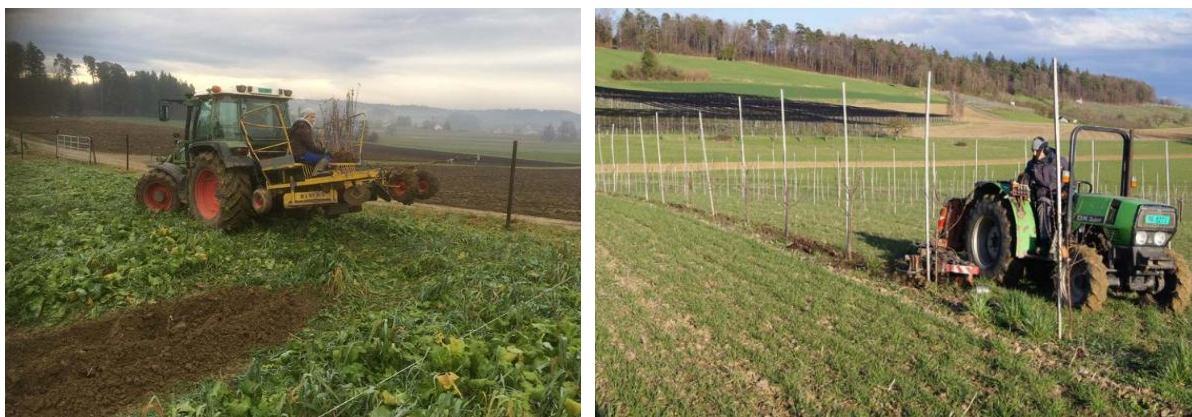
Baumschulpflanzmaschine und Kreisel-Hackgerät mit Tastarm für die Baumstreifenpflege und eine effiziente Arbeitsweise. (Quelle: Jürg Strauss)
